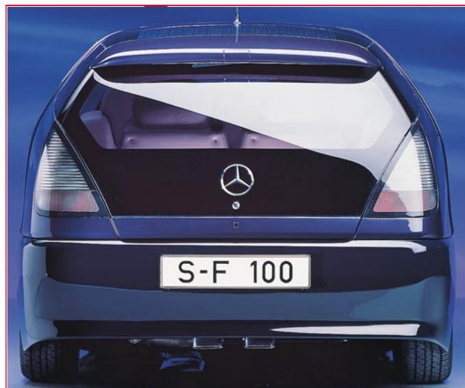
Bild 15: Der Mercedes-Benz-Technologieträger F 100 zeigt Heckleuchten in Lichtleitertechnik in extrem flacher und karosseriebündiger abschließender Bauweise. Foto: Mercedes-Benz.
