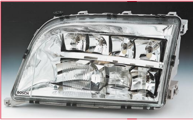
Bild 11: Der Scheinwerfer mit variabler Lichtverteilung besteht aus einer Vielzahl speziell ausgelegter Einzelreflektoren, die durch die Fahrzeugelektronik intelligent gesteuert werden. Foto: Bosch.
