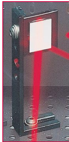
Bild 10: Spiegelhalter mit angeschraubtem Haltewinkel und aufgeklebtem Oberflächenspiegel
