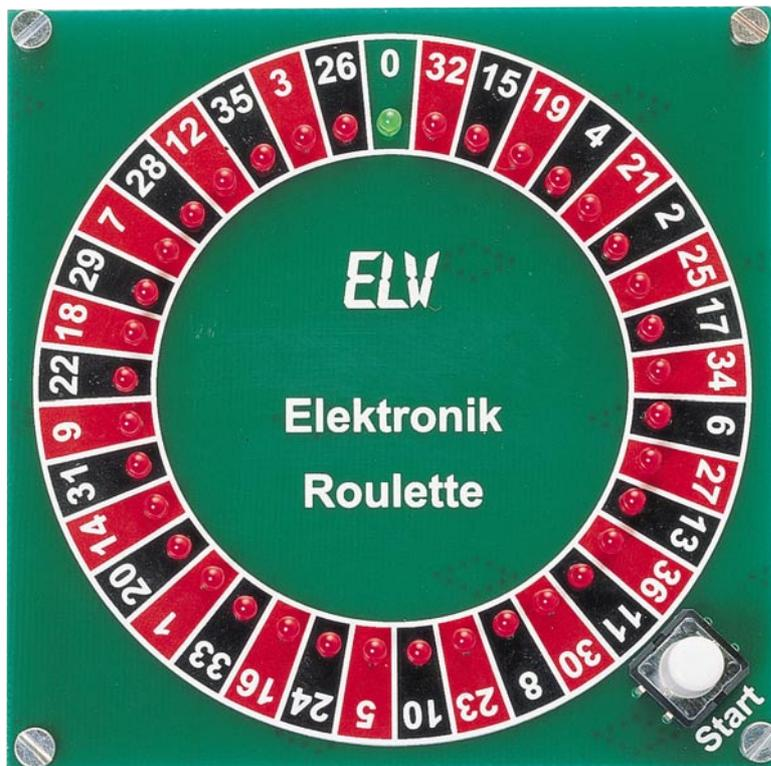
Ansicht der bedruckten Platinenoberseite, die gleichzeitig als Frontplatte dient
