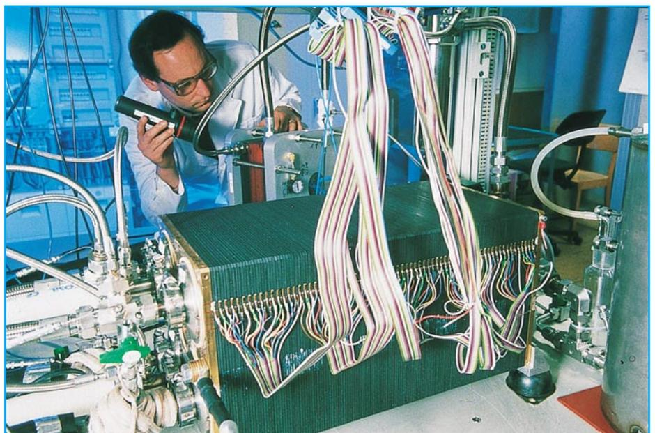
**Bild 5:** Deutlich zu sehen: der Aufbau eines Brennstoffzellen-Stacks aus vielen hundert Einzelzellen - hier im Laboraufbau (Foto: Daimler-Benz)
