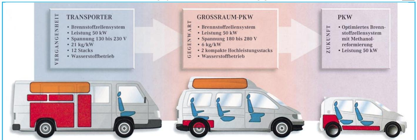
**Bild 7: Die drei Evolutionsstufen des Brennstoffzellenantriebs (Grafik: Daimler-Benz)**
