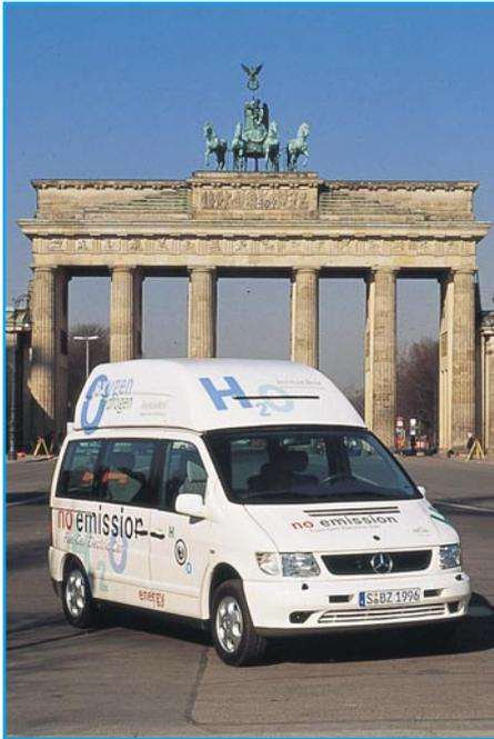
**Bild 6: Äußerlich nur noch am Dachaufsatz vom normalen Fahrzeug zu unterscheiden - der NECAR II ist voll verkehrstauglich und erreicht bereits 250 km Fahrtstrecke mit einer Wasserstoff-Füllung (Foto: Daimler-Benz)**
