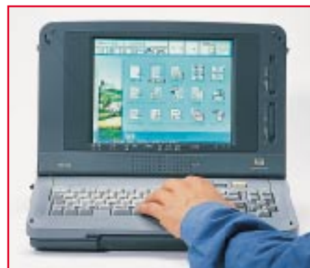
Bild 19: LC-Farbbildschirme finden heute schon massenhaft im Computerbereich Anwendung. Hier ein 10,4"-Display in einem Notebook. Foto: Optrex
