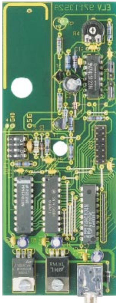
Platine mit zugehörigem Bestückungsplan des Senders
