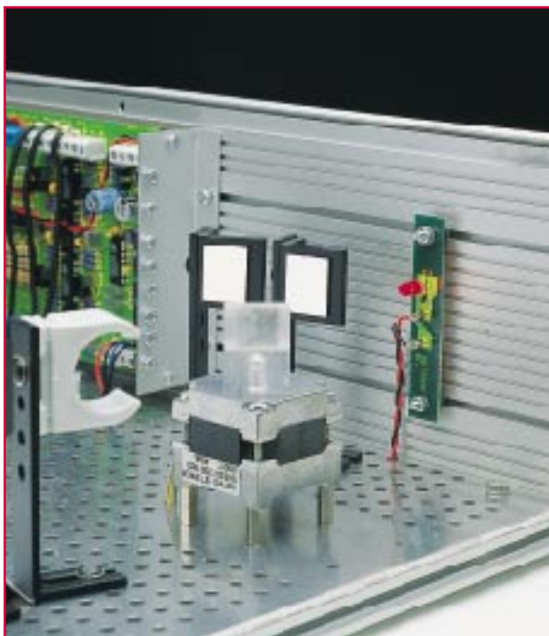
Bild 22: Sensorplatine mit Fotodiode
