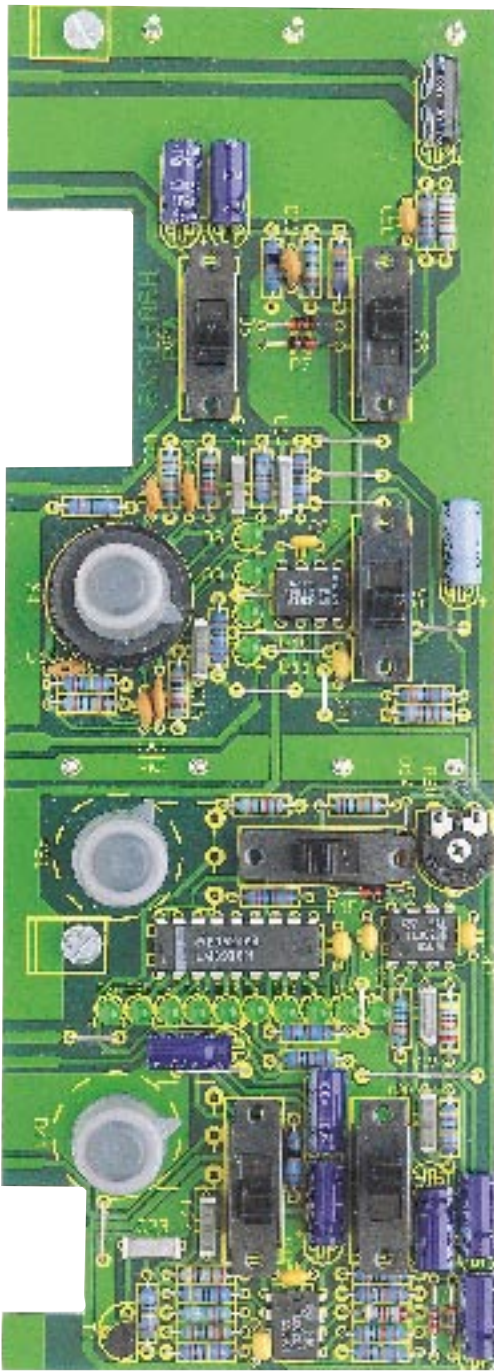
Fertig aufgebaute Frontplatte des Signalverfolgers mit zugehörigem Bestückungsplan
