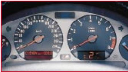
**Bild 5:** Wie in der Formel 1: Das Digitaldisplay im Drehzahlmesser zeigt den Schaltzustand an und gibt Schalterempfehlungen an den Fahrer. (Foto: BMW)
