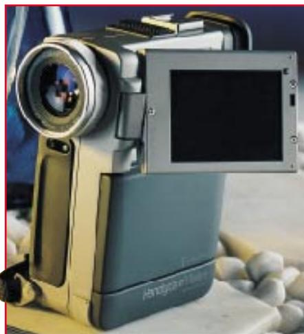
**Bild 4: Auch Sony stellt eine kompakte Handycam vor. Neben dem Sucher ermöglicht ein 6,35cm-Farbdisplay die einfache Kontrolle der Aufnahmen.**
