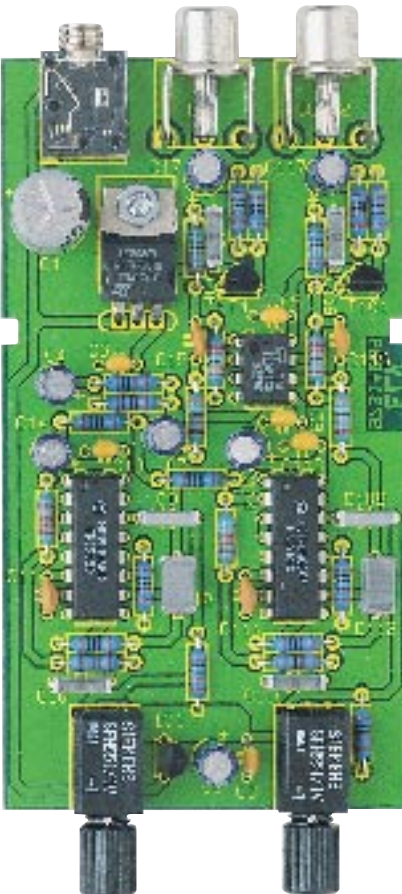
Fertig aufgebaute Platinen, oben Sender, unten Empfänger.
