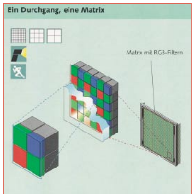
Bild 5: Die Matrixanordnung vieler CCD-Zellen ermöglicht die Bildaufnahme in einem Moment. Grafik: Agfa
