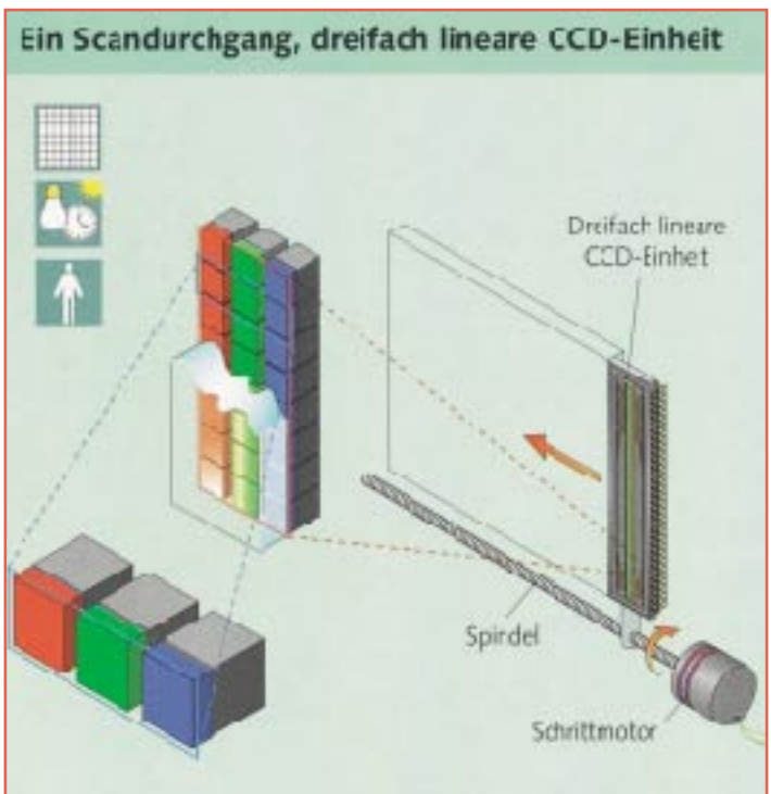
Bild 3 (unten): So arbeitet ein Zeilen-CCD-Scanner. Ein Schrittmotor bewegt die drei CCD-Zeilen exakt über die Bildaufnahme- fläche. Grafik: Agfa
