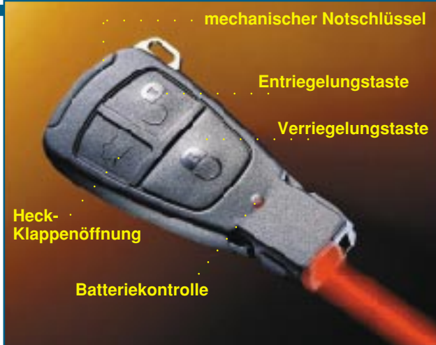
Bild 3: Der Schlüssel für die dritte Evolutionsstufe des Mercedes-Benz-Fahrtberechtigungssystems beinhaltet zahlreiche Schließfunktionen mit zwei Sendern, eine Batteriekontrolle, eine Transponder-/IR-Sender-Kombination für das Starten des Motors und einen mechanischen Notschlüssel. Foto: Mercedes-Benz
