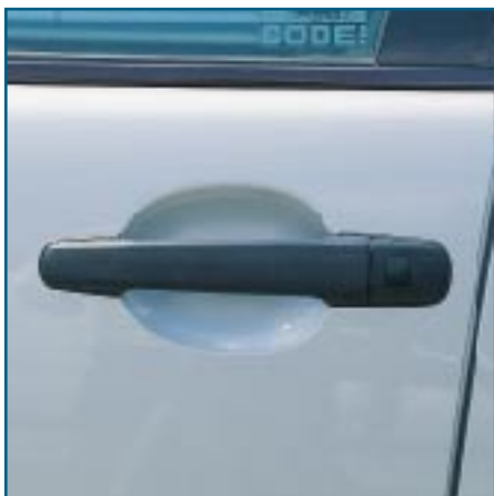
Bild 1: E-Klasse ohne mechanisches Fahrertürschloß. Lediglich zwei Leuchtdioden signalisieren den Status der Schließanlage. Für den Notfall gibt es auf der Beifahrerseite allerdings noch ein stabiles, mechanisches Notschloß.
