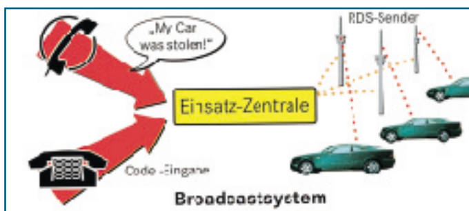
Bild 9: Fernbedienung einmal anders - gezielte Stilllegung der Fahrzeug- elektronik per RDS-Rundfunk- system. Grafik: Mercedes-Benz
