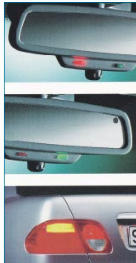
Bild 2: Der IR-Empfänger für die Globalöffnung sitzt am Innenspiegel nebst weiteren Statusanzeigen. Aktivierung und Deaktivierung der Schließanlage wird durch Aufleuchten der Blinkleuchten signalisiert.
