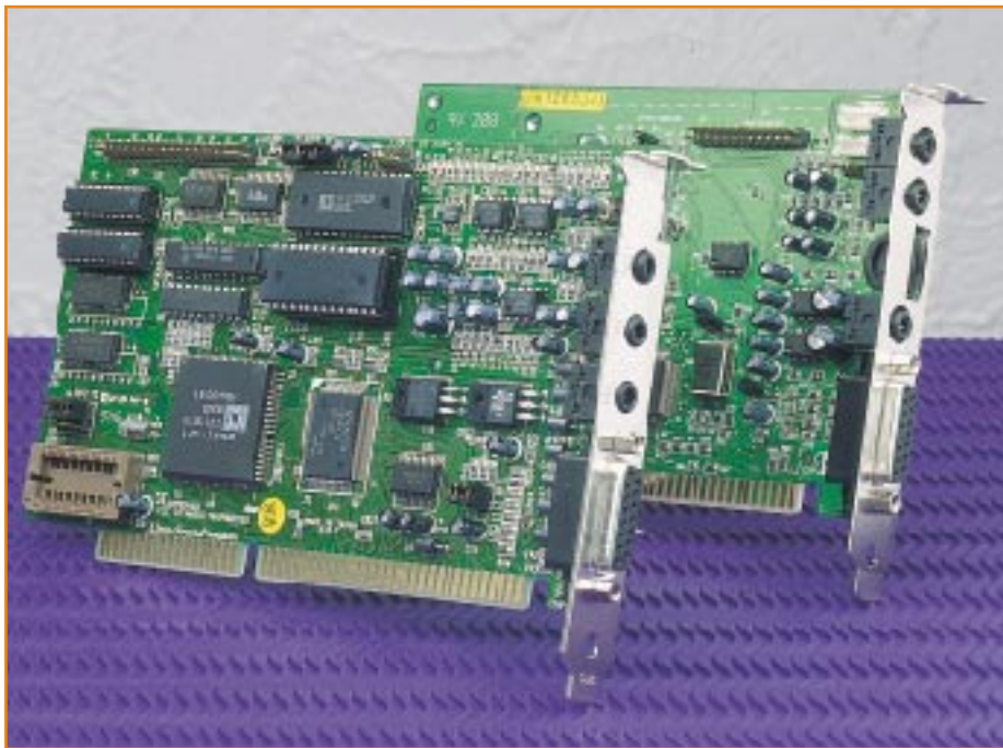
Bild 1: „AudioWave“ bedient sich einer normalen 16-Bit-Soundkarte zur Signalformung und -ausgabe.
