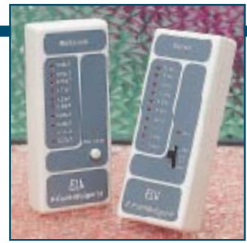
Bild 9: Mit dem ELV-Meßequipment dem Elektrosmog auf den Fersen: H- und E-Feldmeßgerät zur Feststellung von elektrischen und magnetischen Feldern im persönlichen Umfeld. Erst wenn man weiß, wo sich solche Felder befinden, kann man relativ einfache, aber wirksame Präventivmaßnahmen ergreifen.
