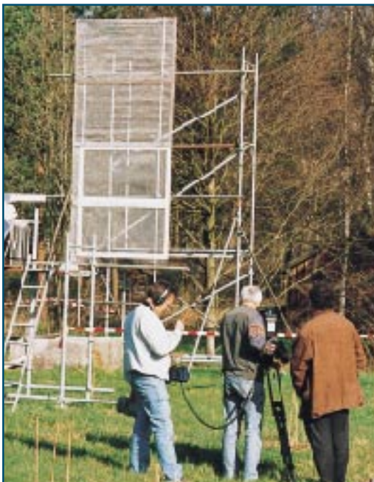
Bild 5: Um die Auswirkungen hochfrequenter Felder auf die Natur zu erforschen, bestrahlt man an der Universität der Bundeswehr München in Zusammenarbeit mit dem Lehrstuhl für Forstbotanik der Ludwigs-Maximilian-Universität München derzeit in einem Feldversuch Bäume mit einem Schiffsradar. Ein Teil der Bäume wird dabei mit einem metallischen Schutznetz abgedeckt. Quelle: Prof. G. Käs, Universität der Bundeswehr, München.
