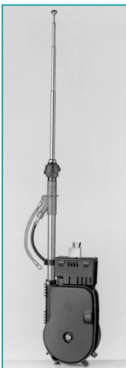
Bild 4: Motorantennen werden im Kotflügel montiert, benötigen jedoch relativ viel Platz unter dem Blech. Sie werden automatisch über den 12V-Steueranschluss des Autoradios aktiviert. (Foto: Hirschmann)
