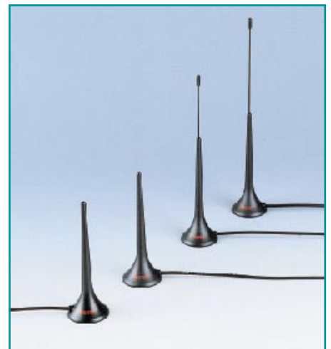
Bild 9: Magnetfußantennen sind sehr universell einsetzbar, vorzugsweise im Dachbereich (Foto: HAMA)
