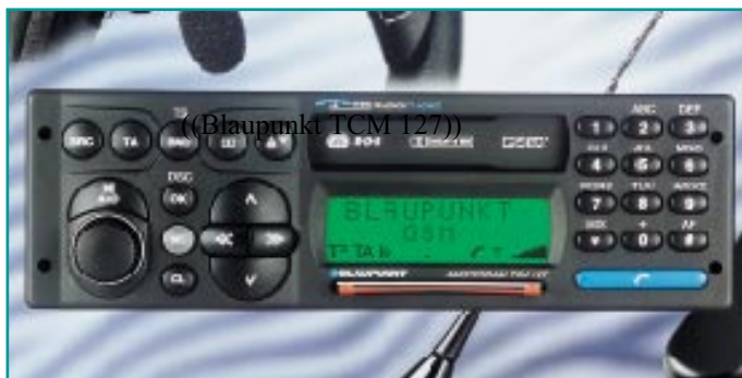
Bild 11: Eines der ersten Kombigeräte für GSM und Radio: Blaupunkt Radiophone Amsterdam TCM 127 (Foto: Blaupunkt)
