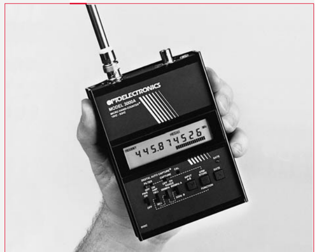
Bild 4: Nahfeld-Frequenzzähler für das Analysieren von Wanzenaktivitäten (Foto: Fink Security Consulting)
