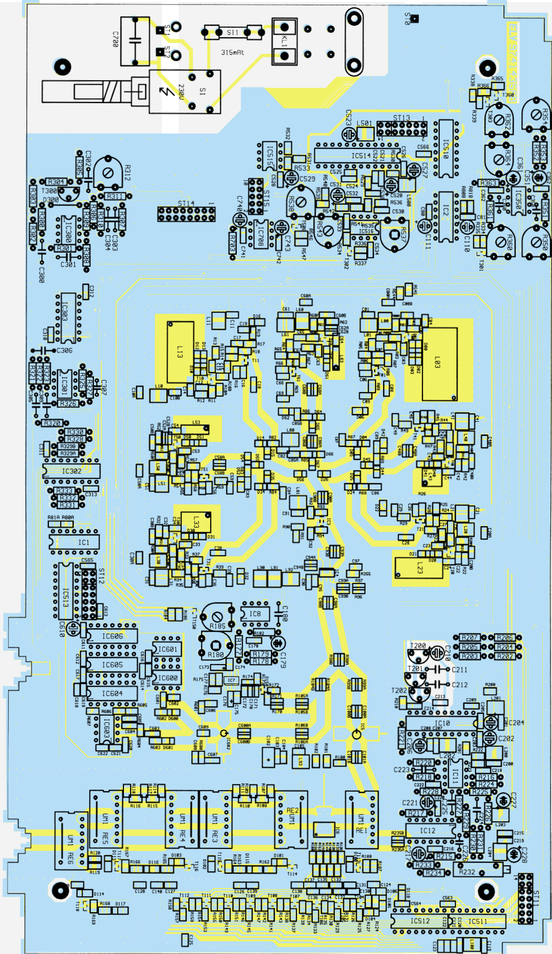
Bestückungsplan der Basisplatte des HFG 9000
