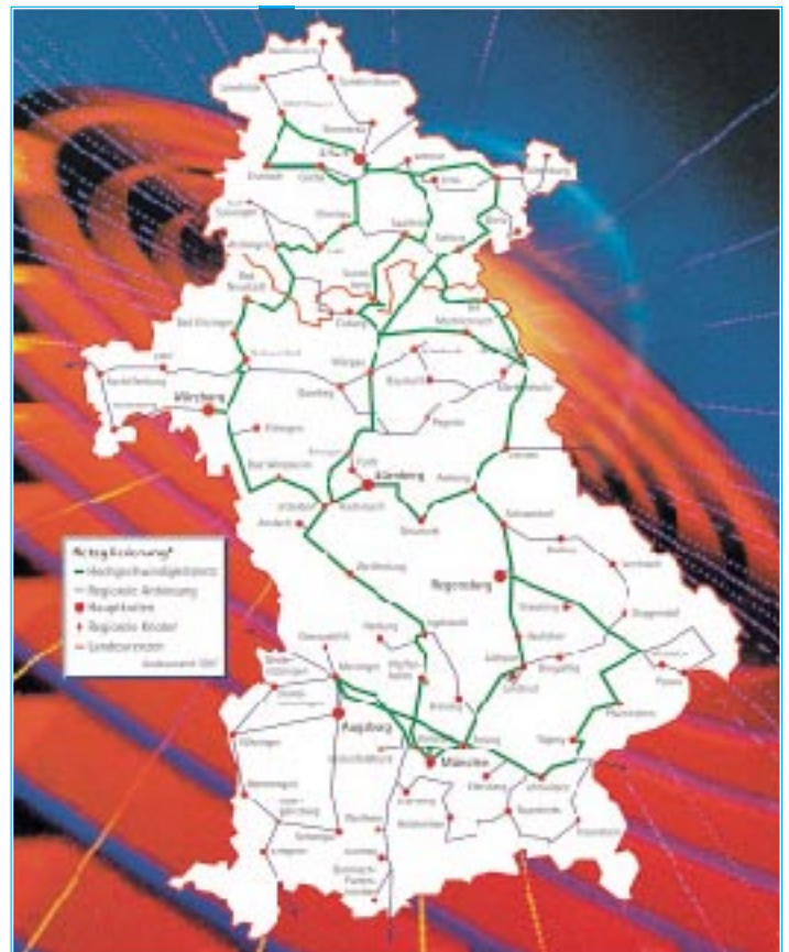
Bild 3: Über leistungsfähige Backbone-Netze, entweder per Glasfaser, Kupfer oder Richtfunk, verfügen alle großen Anbieter. Hier das Hochgeschwindigkeitsnetz der BAYERNWERK NETKOM, einer Tochter der VIAG. (Grafik: BAYERNWERK NETKOM)
