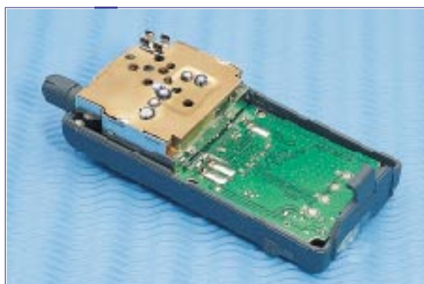
Bild 9: Innenansichten: Ein Blick in das geöffnete PC 400 zeigt, wie kompakt die gesamte Elektronik des Gerätes gestaltet ist, sie benötigt nicht einmal die Hälfte des Gehäusevolumens.
