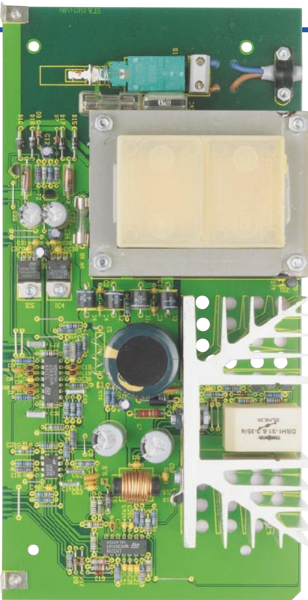
Ansicht der komplett bestückten Basisplatine des SPS 7330
