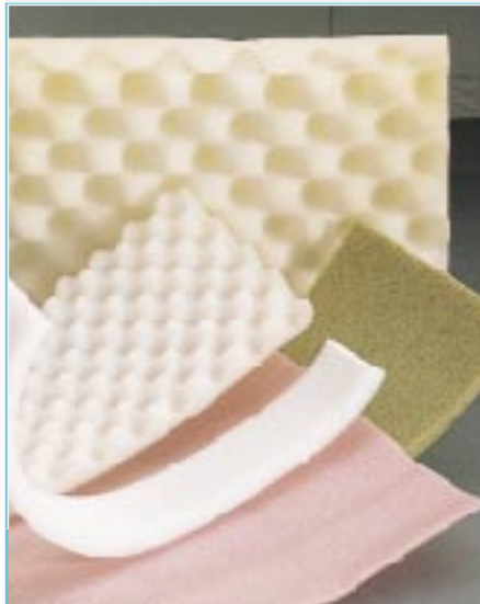
Bild 7: Gut zur individuellen Gehäusedämpfung geeignet - großporiger Schaumstoff und Kfz-Dämmmatten. Besonders genopppter Schaumstoff dämpft hohe Töne wirkungsvoll.
