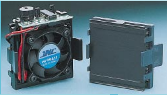
Bild 4: CPU-Lüfter mit Temperaturmelder - alarmiert den Benutzer bei drohender Überhitzung der CPU.
