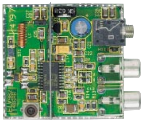
Ansicht der fertig aufgebauten Platine des Video-HF-Modulators mit zugehörigem Bestückungsplan
