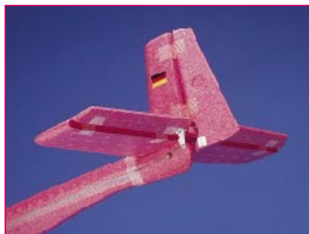
Steck- und Klebverbindungen kennzeichnen den Zusammenbau des Modells.
