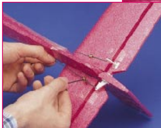
Servo- und Ruderjustage einfach - Steuerhorn senkrecht stellen, Steuergestänge montieren und mit dem Stelling die Ruder in Neutralstellung einstellen.
