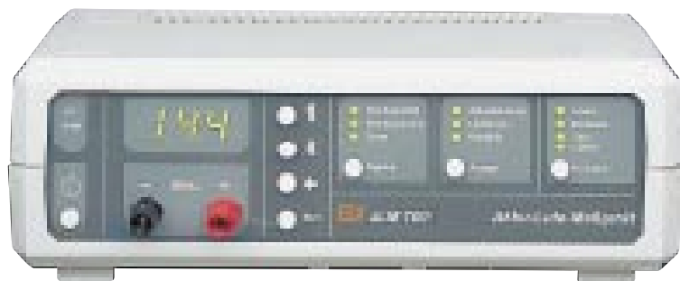
Bild 8: Mikroprozessorgesteuerte Ladegeräte arbeiten weitgehend automatisch, analysieren und pflegen NiCd- und NiMH-Akkus jeder Art.
