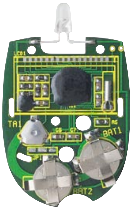
Bild 3: Komplexes Innenleben - der Prozessor erfordert nur wenige externe Bauelemente. Leiterplattenabmessung: 38,0 x 50,8 mm
