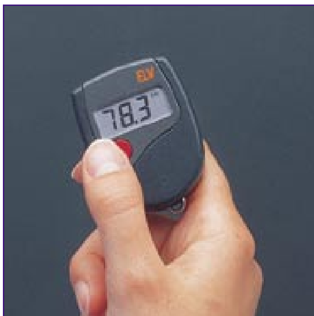
Bild 1: Ein Knopfdruck, und der ScreenCheck SC 200 zeigt die Bildwiederholffrequenz exakt an.
