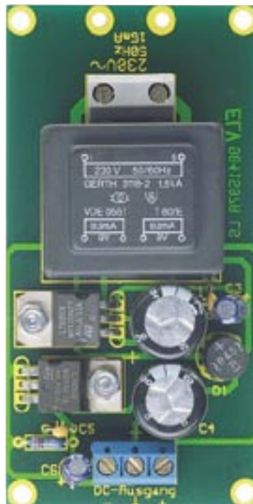
Ansicht der fertig aufgebauten Platine des Mini-Doppelnetzteils MNT 2 mit zugehörigem Bestückungsplan
