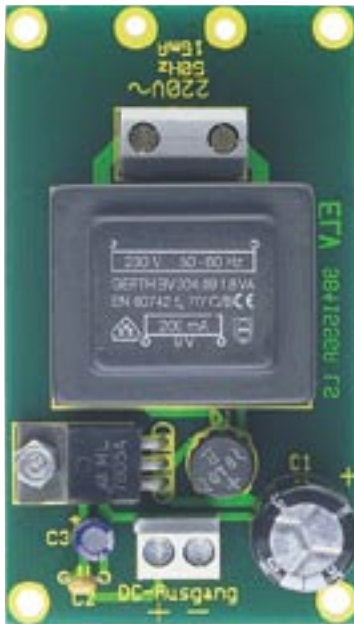
Ansicht der fertig aufgebauten Platine des Mini-Einfach-Netzteils MNT 1 mit zugehörigem Bestückungsplan
