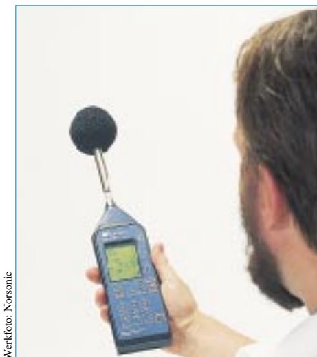
Bild 5: Beispiel für einen integrierenden Schallpegelmesser, mit dem auch zeitlich gemittelte Schallpegel gemessen werden können - für Messungen im Umweltschutz unentbehrlich.
