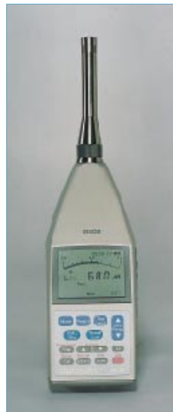
Bild 2: Beispiel für einen integrierenden, analog und digital anzeigenden Präzisions-Schallpegelmesser
