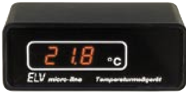
Bild 1: Der Beginn der Fernmeßtechnik: Thermometer mit zusätzlichem Außenfühler.
