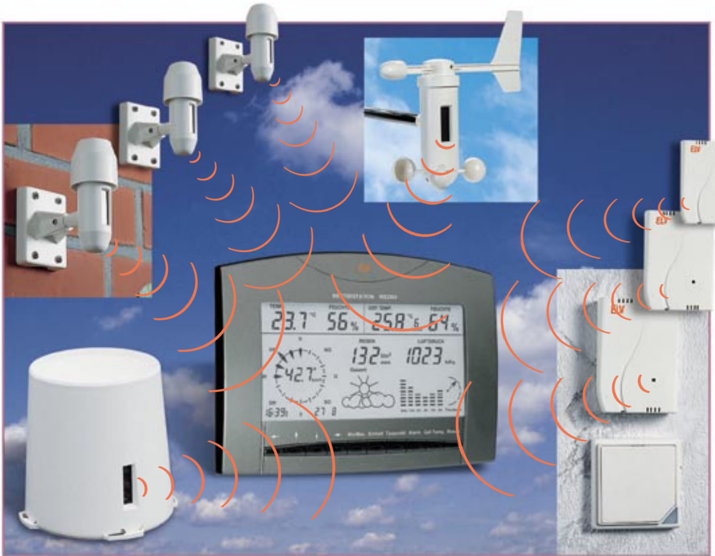
Bild 3: Ungebunden durch Datenübertragung per Funk - die vielfältige Sensortechnik rund um die WS 2000.
