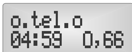
Bild 5: Das Display hält Sie immer auf dem laufenden: es zeigt gleichzeitig den aktuellen Anbieter, die Gesprächsdauer und die aufgelaufenen Gebühren an.
