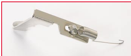
Bild 4: Die Zugfedern der 1,5V-Ladeschächte sind entsprechend dem Foto an die Minuskontakte anzulöten. Das Lötzinn darf nur innerhalb der Öse verlaufen.
