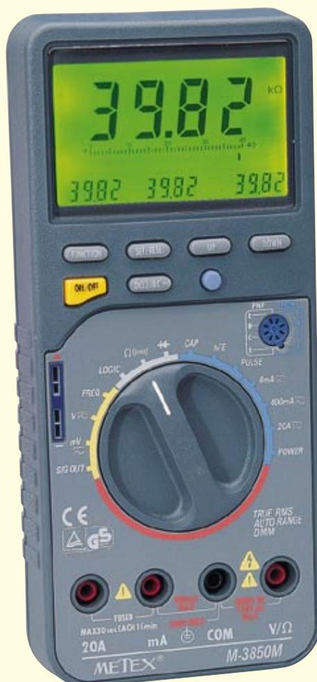
**Bild 61: Multimeter mit integriertem Logikpegeltester**
