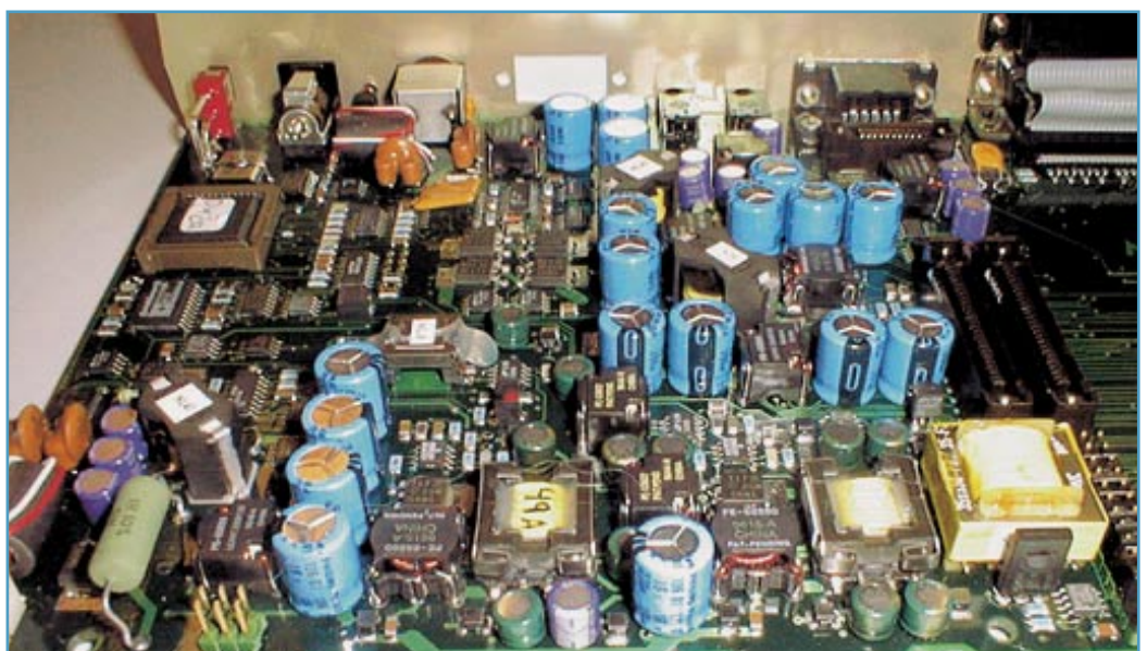
Bild 13: Blick auf eine Elektronik-Platine eines mit einem hochwertigen Frequenz-Analysator ausgestatteten Schallpegelmessers (enviornmental analyser) Typ 121 (Werkfoto Norsonic)
