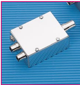
Bild 16: Kein A/V-Anschluß? Mit einem UHF-Modulator läßt sich das Kamerasignal in jeden Fernseher einspeisen.
