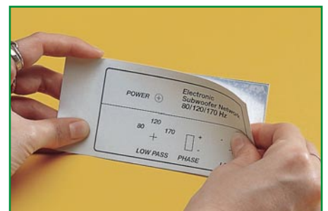
Bild 7: So erfolgt das Aufkleben eines Papiausdrucks auf die Frontplatte mit Doppelklebefolie.
