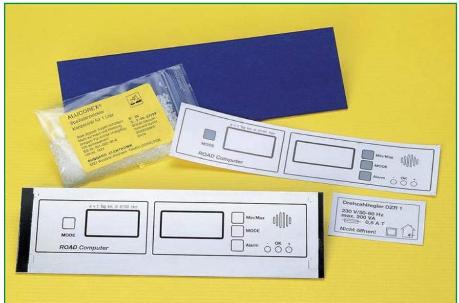
**Bild 12: Höhepunkt des Frontplatten-Eigenbaus: Mit Fotopositiv-Lack beschichtete Alucorex-Frontplatte.**
