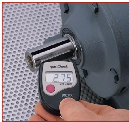
Bild 3: So präpariert man eine Motorwelle für die Drehzahlmessung.
