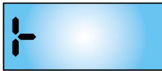
**Bild 5: Messung gestartet, indem Kontakt 1 durchfahren wurde**
