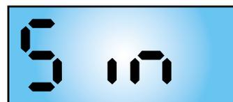
**Bild 2: Single-Mode (neue Messung muß manuell gestartet werden)**
