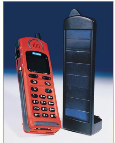
**Bild 9: Akku leer? Keine Netzsteckdose in Sicht? Der Solarlader für das Handy ist die Lösung fernab der Zivilisation. (Bild: Fraunhofer ISE)**
