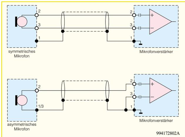
**Bild 1: Möglichkeit einer Ankopplung mit einem Differenzverstärker als Eingangsstufe, wie wir ihn auch in unserer Schaltung einsetzen. Im oberen Teil der Abbildung ist der Anschluß eines symmetrischen, im unteren Teil die eines asymmetrischen Mikrofons dargestellt.**
