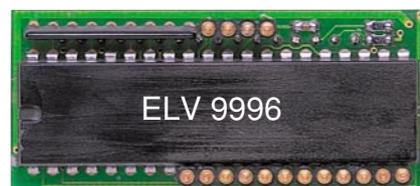
**Ansicht der fertigen Bestückungsseite der Basisplatine mit IC 1 und den Kontaktleisten**
