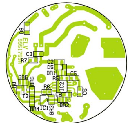
Ansicht der fertig bestückten Platine des DI 300 von der Lötseite mit zugehörigem Bestückungsplan
