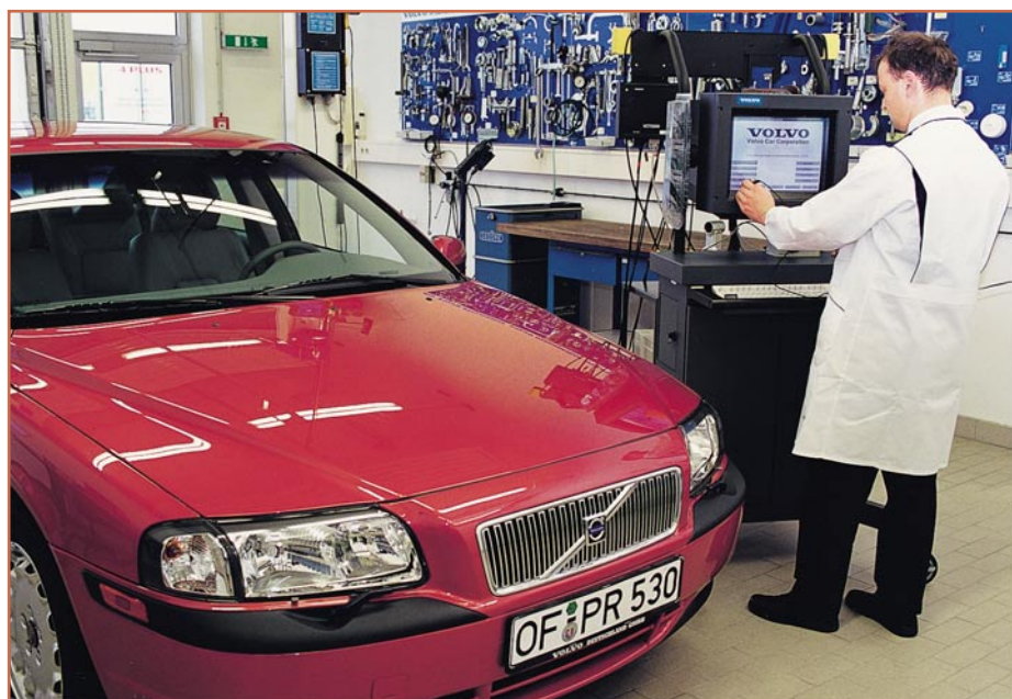
Bild 2: Das VADIS-System ermöglicht es, per Online-Verbindung zum Hersteller jedem Volvo S80 eine individuelle Software zuzuweisen. Foto: Volvo
