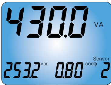
Bild 2: Hier wird die Scheinleistung, Blindleistung und der Leistungsfaktor je Verbraucher angezeigt.
