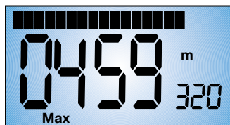
Bild 8: Eine der erweiterten Funktionen des VAM 200 - Anzeige der maximal erreichten Höhe. Oben signalisiert die Bargraphanzeige eine bereits abgesunkene Akkuspannung im Modell an.
