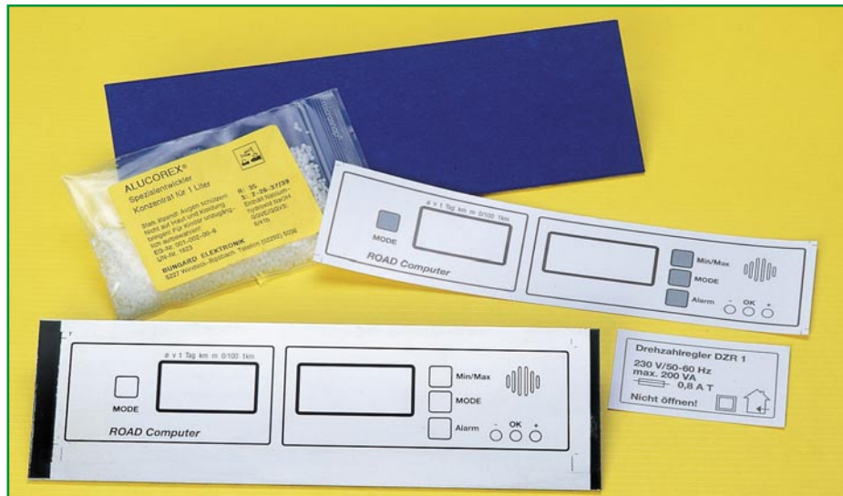
Bild 4: Hochqualitativer Frontplattenbau mit fotopositiv beschichteter Alucorex-Frontplatte
