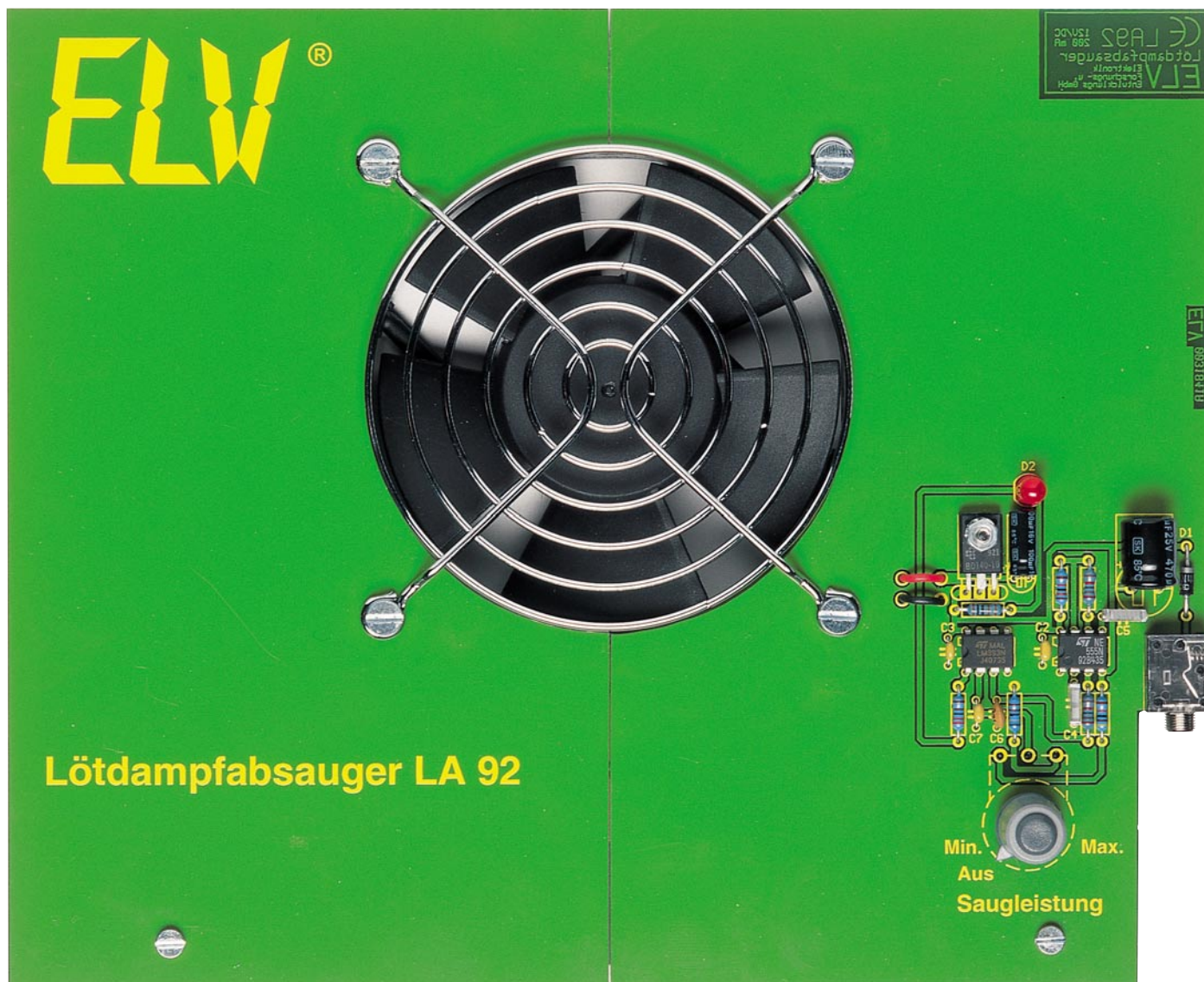
Ansicht der fertig bestückten Platine des Löt dampfabsaugers LA 92 (Originalgröße: 220 x 180 mm)
