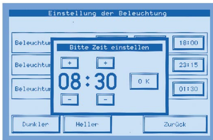
Bild 9: Selbst für die Beleuchtungssteuerung gibt es komfortable Einstellmöglichkeiten, wie 3 Schaltzeiten täglich, Timer und Dimmer.
