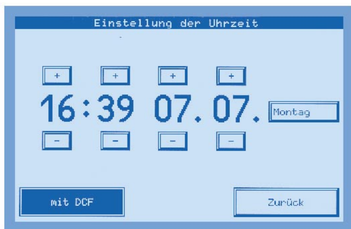
Bild 8: Das Einstell-Fenster für Uhrzeit, Datum und Wochentag sowie Aktivierung/ Deaktivierung des DCF-Empfangs
