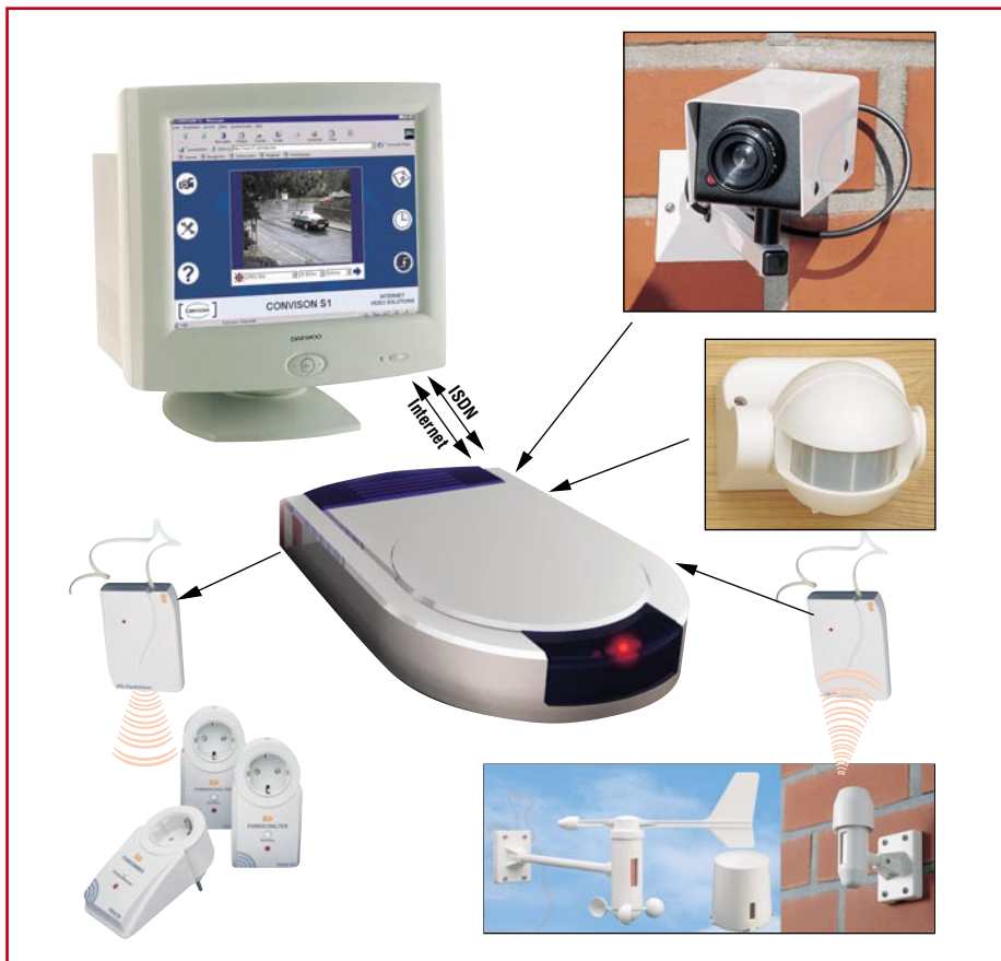
Bild 4: Ein kleiner Webserver schickt die Bilder Ihrer Überwachungskamera ins Internet.
