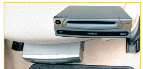
Bild 21: Der Rechner fand unter dem Fahrersitz seinen Platz und ist bei normaler Fahrersitzstellung nicht zu sehen.
