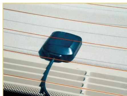
Bild 23: Einfache Montage: Die GPS-Antenne im Heckfenster
